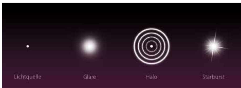
Abb. 2: Lichtquelle-Glare-Halo-Starburst. Quelle: Norman Marx@domed.
